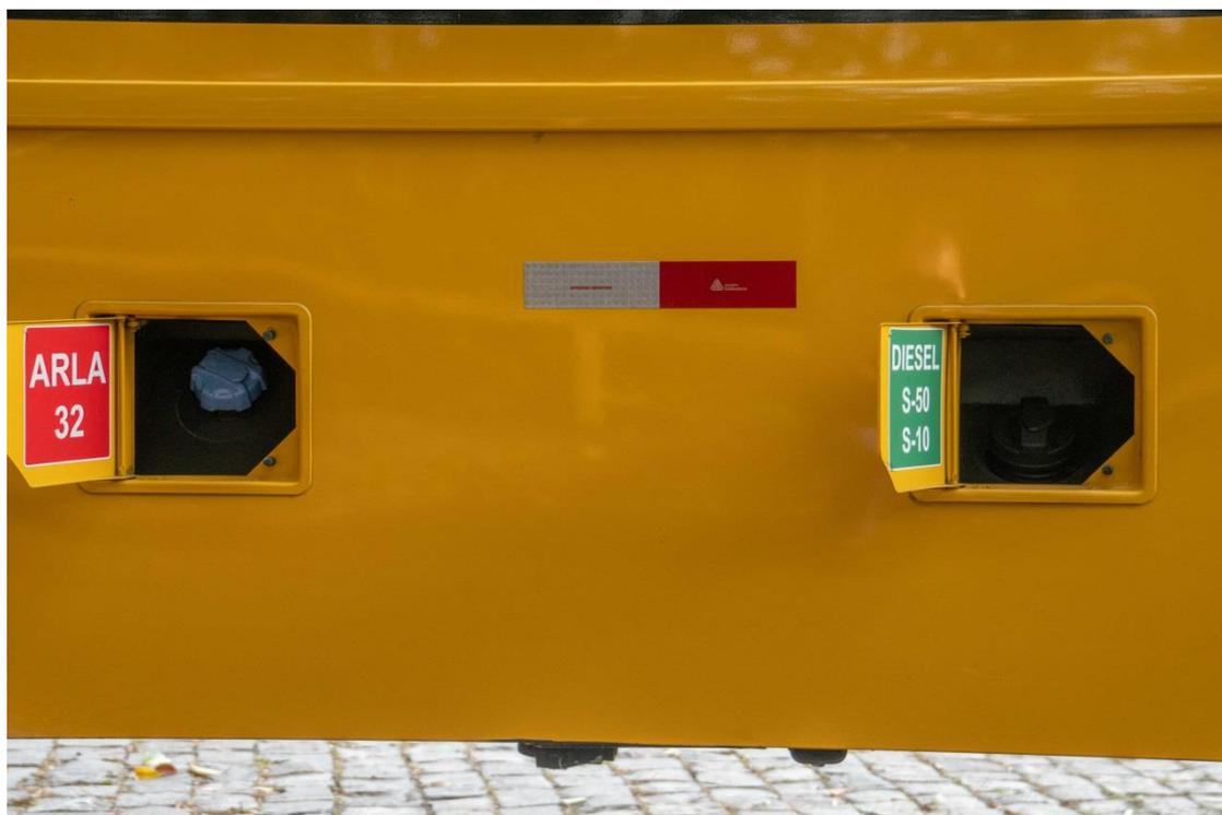
**Foto 26:** Tampa do tanque do agente redutor de NOx (gás poluente) e de combustível
