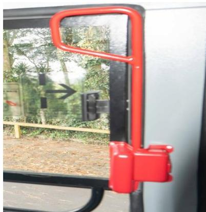
**Foto 14:** Alavanca de emergência.
